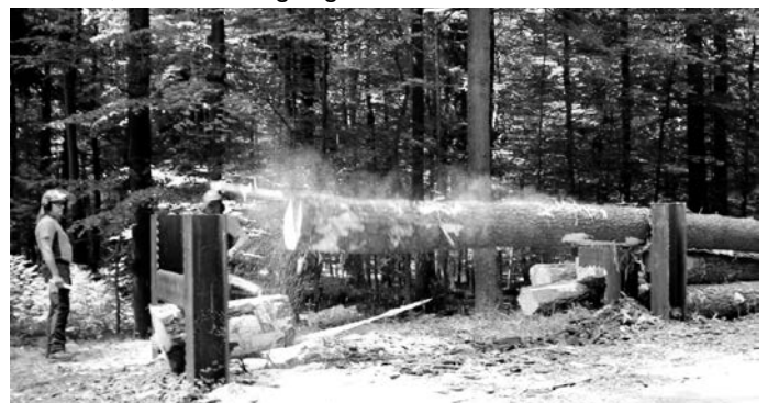
Ein Forstwirt des Kreisforstamtes nimmt einen Trennschnitt vor an einem Stamm, dessen Spannung künstlich vom Spannungssimulator erzeugt wurde. Foto: RNK
